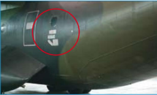
Die **hinteren Ausstiegsluken** befinden sich rechts und links hinter den Fahrwerksgondeln.
