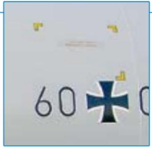
**Einschlagzonen** befinden sich nur rechts hinter der Rumpfmittle, hinter und oberhalb dem Tragflächenende und sind gelb gekennzeichnet.
