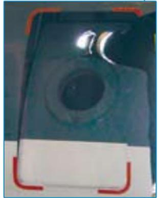
Den Drehgriff der **Notausstiegsluke** im Uhrzeigersinn drehen - Türen nach innen drücken und Treppe ausklappen.
