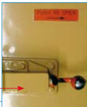
Bei **nicht erfolgtem Druckausgleich** lassen sich möglicherweise die Druckkabinentür bzw. die Noteinstiege nicht öffnen. In diesem Fall kann zur **Herstellung** des **Druckausgleichs** ein Fenster (z.B. in einem Noteinstieg oder im Führerraum) eingeschlagen werden.
