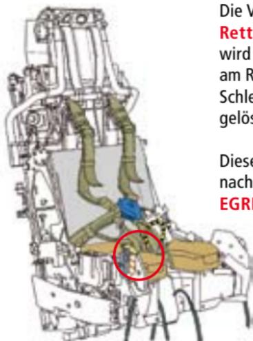
Die Verbindung zum **Rettungsboot** wird mit einem Drehknopf am Rand des Schleudersitzes rechts vorne gelöst.
