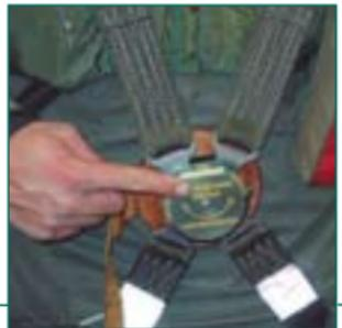
Der Bordmechaniker kann in einem **Stehhaltegurt** oder der **Modularen Rettungsweste** am Luftfahrzeug befestigt sein. Sicherungsfeder an der gelben Lasche abziehen, den Drehknopf 90° drehen und auf den Drehknopf drücken.
