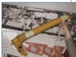
EUROFIGHTER ist mit einer fest am Lfz installierten **Bordleiter** ausgerüstet. Bei Nutzung ist neben dem CANOPY-Schalter der Vierkantkopfschalter zu betätigen (Bezeichnung LADDER).
