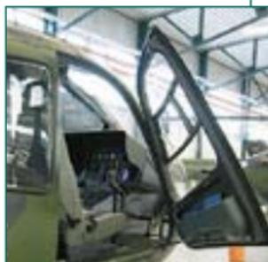
Die **Schiebetüren** rechts und links durch Drehen des Türgriffes nach oben entriegeln und dann nach hinten schieben.
