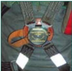
Der Bordmechaniker kann in einem **Stehhaltegurt** oder der **Modularen Rettungsweste** am Luftfahrzeug befestigt sein. Sicherungsfeder an der gelben Lasche abziehen, den Drehknopf 90° drehen und auf den Drehknopf drücken.
