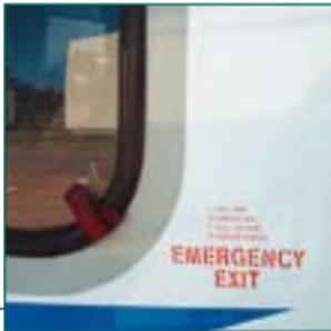
Die **Fenster** können ebenfalls als Notausstiege benutzt werden. Das rote Band abreißen und die Fensterdichtung kann abgezogen werden. Mit dem zweiten Band wird das Fenster entnommen.
