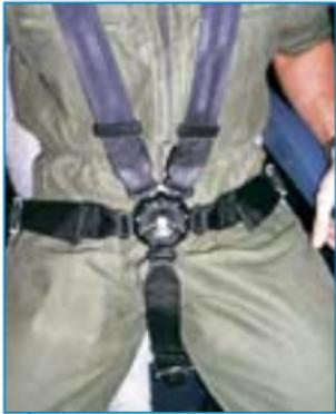
Die **Gurte** der **Crew** werden durch eine Drehung des Zentralschlusses geöffnet.
