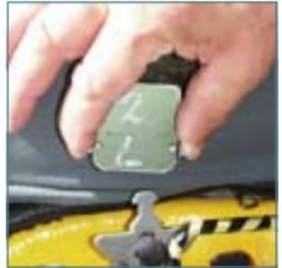
Die **Beatmungsanschlüsse** der Besatzung am Schleudersitz werden durch einen Hebel gelöst (PEC-Teil).
