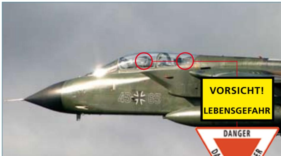
Dieses Zeichen befindet sich an beide Rumpfsseiten von Militärluftfahrzeugen unterhalb des Kabinendaches. Es bedeutet, dass die Insassen auf einem Schleudersitz sitzen.
