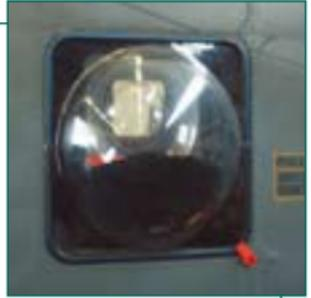
Die **Fenster** an der Rumpfseite werden durch ziehen an der roten Lasche aus dem Rahmen gelöst. Die gewölbte Scheibe lässt sich ebenfalls so lösen.
