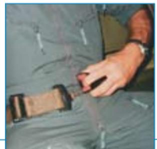
Die **Gurte** der Passagiere werden mit dem roten Druckknopf geöffnet.
