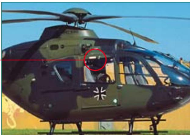
Die **Cockpittüren** rechts und links lassen sich durch Drehen des Türgriffes in die OPEN-Position öffnen.
