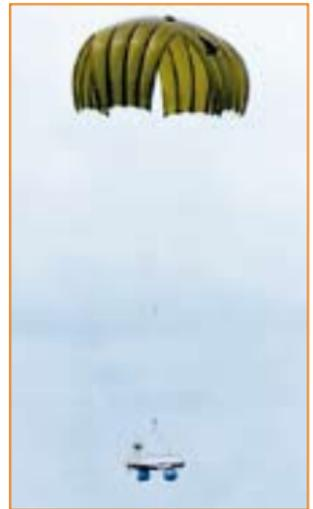
Die Drohne KZO (Kleinfluggerät Zielortung) ist ein propellergetriebenes ULfz, welches zu Aufklärungszwecken eingesetzt wird. Die Landung erfolgt ausschließlich am Fallschirm.
