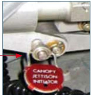
Dieser **Stift** gehört in die gekennzeichnete Buchse hinter der linken Konsole etwas hinter dem Schleudersitz.
