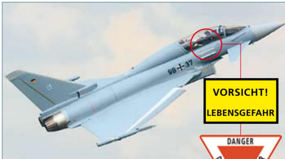
Dieses Zeichen befindet sich an beide Rumpfsseiten von Militärluftfahrzeugen unterhalb des Kabinendaches. Es bedeutet, dass der Insasse auf einem Schleudersitz sitzt.
