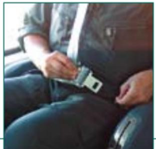
...indem am Schloss die Entriegelung angehoben wird.
