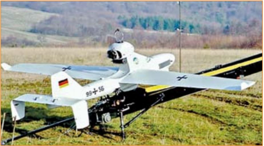
Die Drohne LUNA (Luftgestützte Unbemannte Nahaufklärung-Ausstattung) ist ein propellergetriebenes leichtes Drohnensystem, welches für die Echtzeit-Luftaufklärung und -Überwachung eingesetzt wird.
