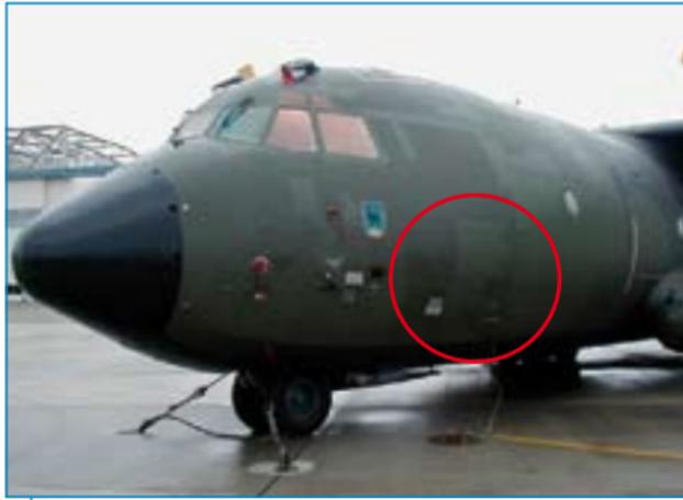
Die vordere **Ausstiegsluke** befindet sich am linken Teil des Rumpfs seitlich versetzt hinter dem Cockpit.
