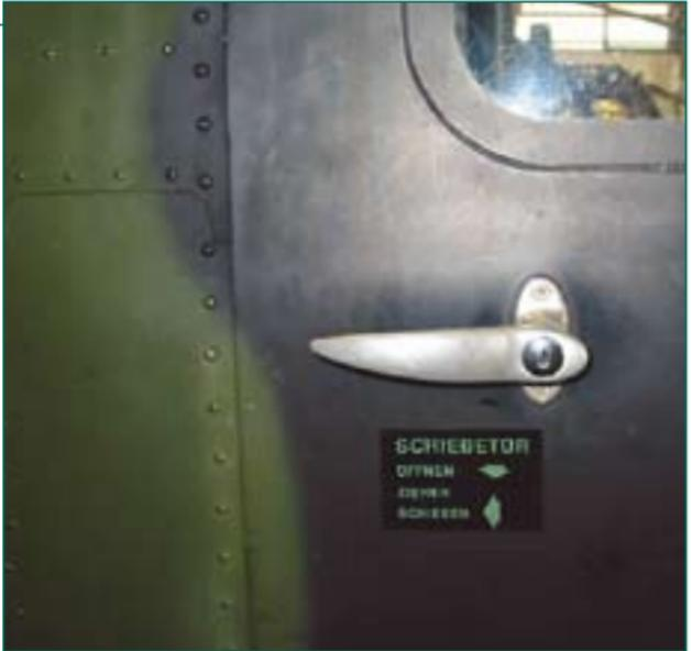
Die **Schiebetüren** rechts und links durch Drehen des Türgriffes nach unten entriegeln, den Griff ziehen und dann seitlich nach hinten schieben.
