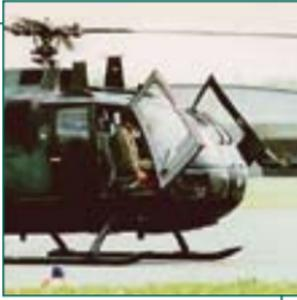
Die **Cockpittüren** rechts und links lassen sich durch Drehen des Türgriffes nach unten öffnen.
