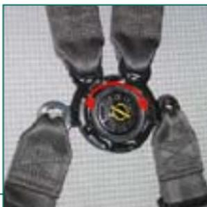
Mit einer 90°-Drehung des Drehgriffes wird das Schloss geöffnet.
