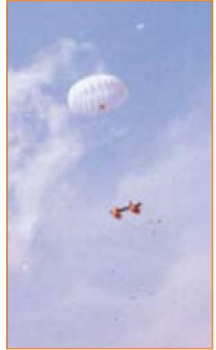
Die Drohne CL 289 ist ein durch ein Strahltriebwerk angetriebener Lenkflugkörper, der zur Luftbildaufklärung verwendet wird. Die Landung erfolgt ausschließlich am Fallschirm.
