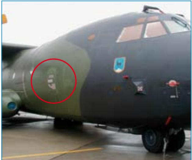
Zusätzlich befindet sich eine **Ausstiegsluke** rechts hinter dem Cockpit nach hinten versetzt.
