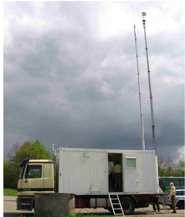
Der Einbau einer mobilen Basisstation in einen Lkw konnte durch die funktechnischen Kenntnisse der Mitarbeiter der Autorisierten / Vorhaltenden Stelle möglich gemacht werden. Für größere Höhen bis 32 Meter, für die die am Container angebrachten Antennenmasten nicht ausreichend sind, kann mit dem ebenfalls beim Bereitschaftspolizeipräsidium verfügbaren Antennenanleger die entsprechende Höhe erreicht werden.
