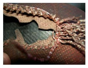
Der Ablösetrupp beobachtete beim Hochgehen vom Erdgeschoss ins Obergeschoss das Platzen eines Schlauches der Angriffsleitung des Trupps C. Der geplatzte Schlauch zeigte ein ungewöhnliches Schadenbild.
