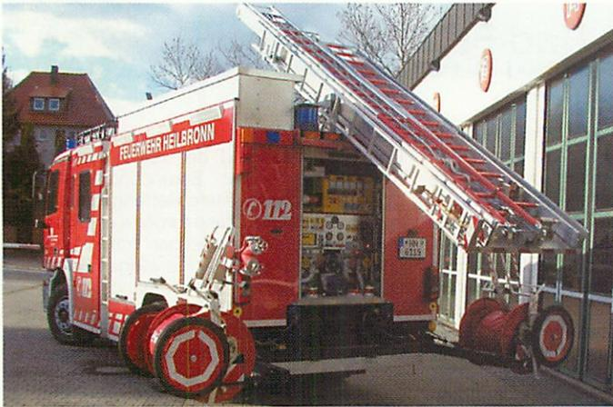
Heckansicht mit abgeklappten Einmannhaspeln und der abgesenkten Vorrichtung zur Leiterentnahme.
