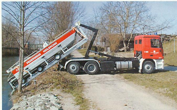
Das MBZ wird mit dem Wechselladerfahrzeug zu Wasser gebracht.
