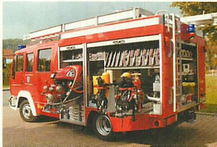
Die auf dem Auszug gelagerte TS 8/8 in Geräteraum 1 sowie zwei auf einem Auszug gelagerte Pressluftatmer in Geräteraum 3.
