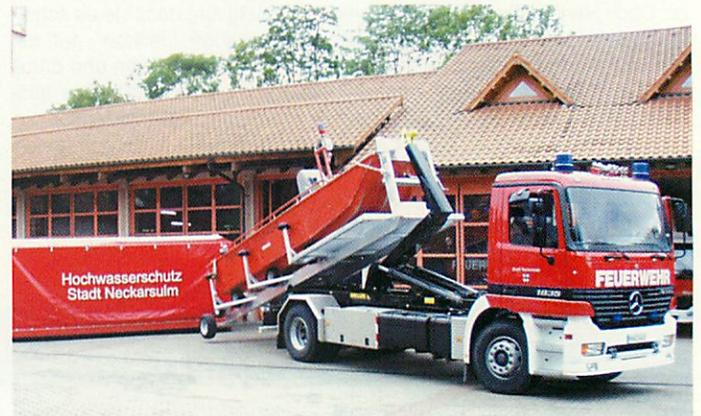
Das Wechselladerfahrzeug mit Boot. Daneben der Abrollbehälter Hochwasserschutz
