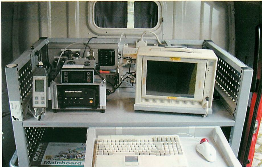
Blick auf den im Fahrzeug untergebrachten Messcontainer mit folgenden Systemen: elektrische Versorgungseinheit (Gleich-/Wechselstrom), Rechner mit Hard- und Software, chemisches Messsystem (Ionenmobilitätsspektrometer <IMS> und Photoionisationsdetektor <PID>), radiologisches Messsystem, Navigationssystem (GPS)
