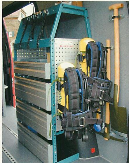
Blick durch die geöffnete Heckklappe auf die beidseitig eingebauten Regalelemente zur Unterbringung der persönlichen Schutzausrüstung.
