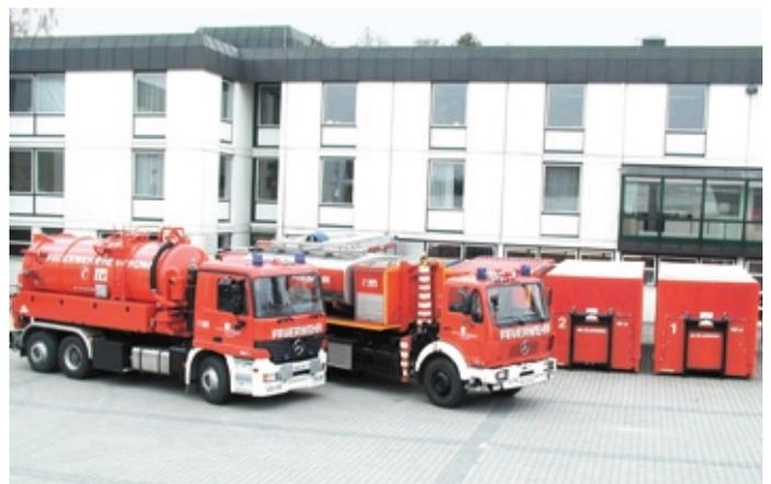
Ein beheizbarer Abrollbehälter-Aufenthalt dient bei größeren Einsätze zur Unterbringung von evakuierten Personen oder als Besprechungs- und Aufenthaltsraum für die Einsatzkräfte.
