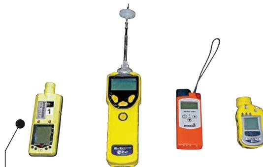
Vierfachmessgerät, Photoionisationsdetektor (PID), Erdgas-Messgerät, CO<sub>2</sub>-Messgerät
