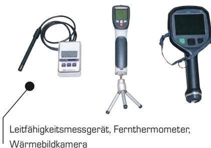
Leitfähigkeitsmessgerät, Fernthermometer, Wärmebildkamera
