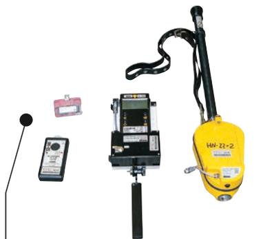
Dosisleistungswarngerät, OSL Dosimeter, Dosisleistungsmessgerät, Teletectorsonde
