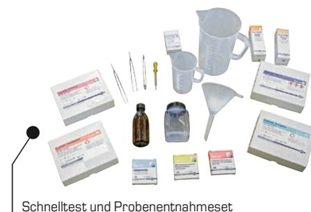
Schnelltest und Probenentnahmeset
