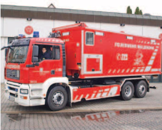
Der Abrollbehälter AB-Atem-/ Strahlenschutz auf dem Wechselladerfahrzeug.
