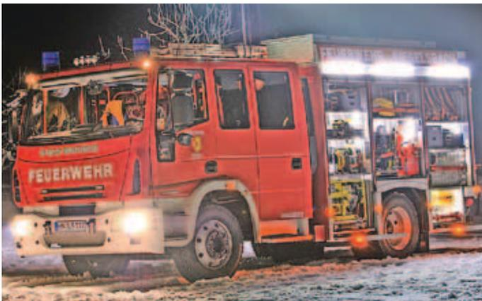
Das neue Löschgruppenfahrzeug – ein LF 10/6 von Iveco ist mit einem umfangreichen Hilfeleistungssatz ausgestattet.
