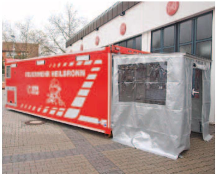
Der Abrollbehälter mit Markise (Rückseite) und Einhängzelt an der geöffneten Heckklappe.
