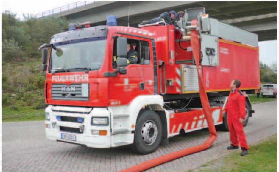
Das Wechselladerfahrzeug mit Abrollbehälter Wasserversorgung – hier: Automatische Wiederaufnahme der F-Schlauchleitung.
