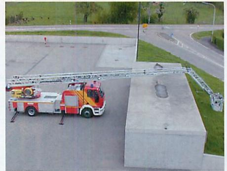
Mit dem abwinkelbaren Gelenkarm und dem teleskopierbaren Leiterteil kann die Drehleiter vielseitig eingesetzt werden
