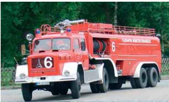
Das Flugfeldlöschfahrzeug FLF 24 S-8, mit einer Tankkapazität von 12000 l Wasser
