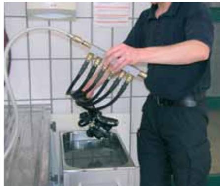
Reinigung und Desinfektion der Lungenautomaten
